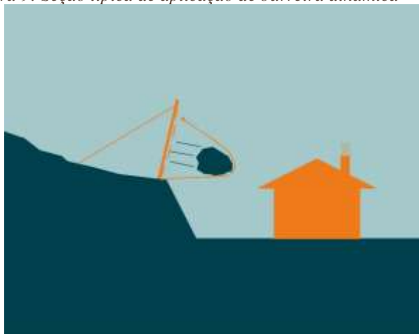
Figura 9: Seção típica de aplicação de barreira dinâmica
